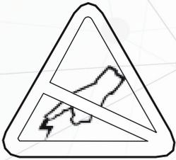
A descarga de energia eletrostática que se acumula na superfície do corpo humano ou em outras superfícies pode danificar ou destruir a cabeça de impressão ou componentes eletrônicos usados neste dispositivo. **TOME PRECAUÇÕES ANTIESTÁTICAS** antes de manusear a cabeça de impressão ou os componentes eletrônicos sob o conjunto da cabeça de impressão.
